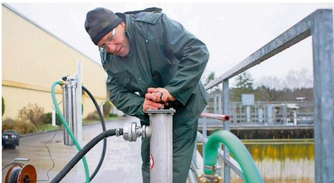
Wasser Marsch: Markus Simmler öffnet den Testlauf in der Kläranlage. Das Klärwasser läuft durch den schwarzen Schlauch in das «Waterflow»-Gerät links hinter Simmler. Darin wird es durch den eingebauten Filter und die UV-C-Röhre gereinigt und läuft durch den grünen Schlauch zum Durchflussmesser, den Simmler beobachtet. Bild: Thierry Haecy
