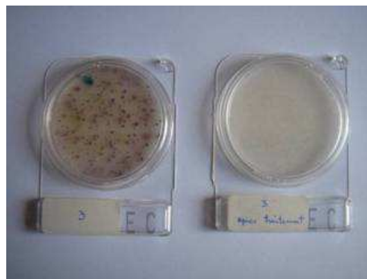
Foto Nr. 31 E-Coli - Kolonien auf 2 Compact Dry, behandelt mit je 1 ml unbehandeltem und 1 ml behandeltem Wasser, Bestrahlungsdauer mit UVC 5 Min.
