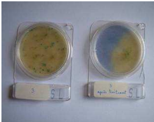
Foto Nr. 32 Salmonellen - Kolonien beobachtet auf 2 Compact Dry 1 x mit 1 ml unbehandeltem Wasser, 1 x mit behandeltem Wasser, Bestrahlungsdauer 5 Min.
