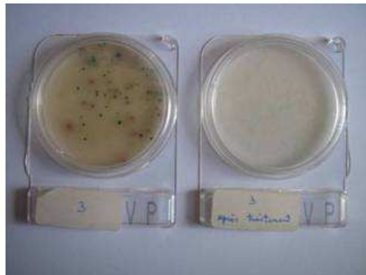
Foto Nr.30 Vibrio p- Kolonien auf 2 Compact Dry je 1 ml von unbehandeltem und von behandeltem Wasser, Behandlungsdauer 5Min.
