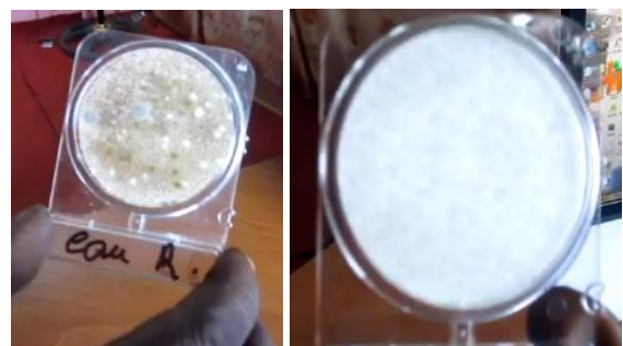
Linkes Bild zeigt das verschmutzte Stadtwasser aus der Leitung. Rechtes Bild zeigt das Stadtwasser nach der 5 Min Bestrahlung mit UVC im Waterdrop 2 System.
